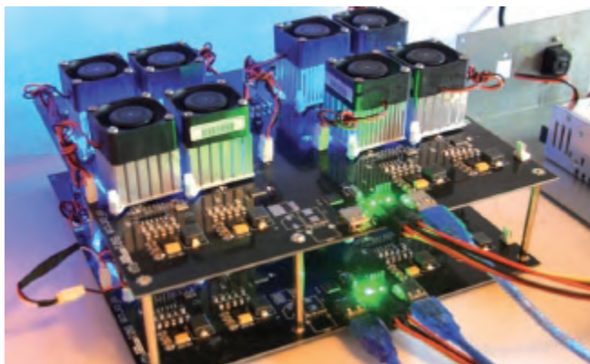
Rys. 2. 8-rdzeniowy procesor FPGA – Bitcoin Miner, 1,6 Ghash/s, 85 W (bitcointalk.org)
